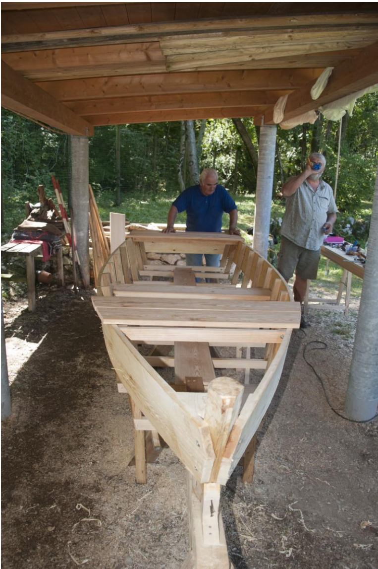
Maurizio (maestro d'ascia) e Piero (collaboratore veneziano) mentre montano le sovrastrutture di prua con Albano (pescatore di Alesso) che ricorda le caratteristiche delle barche di Alesso
