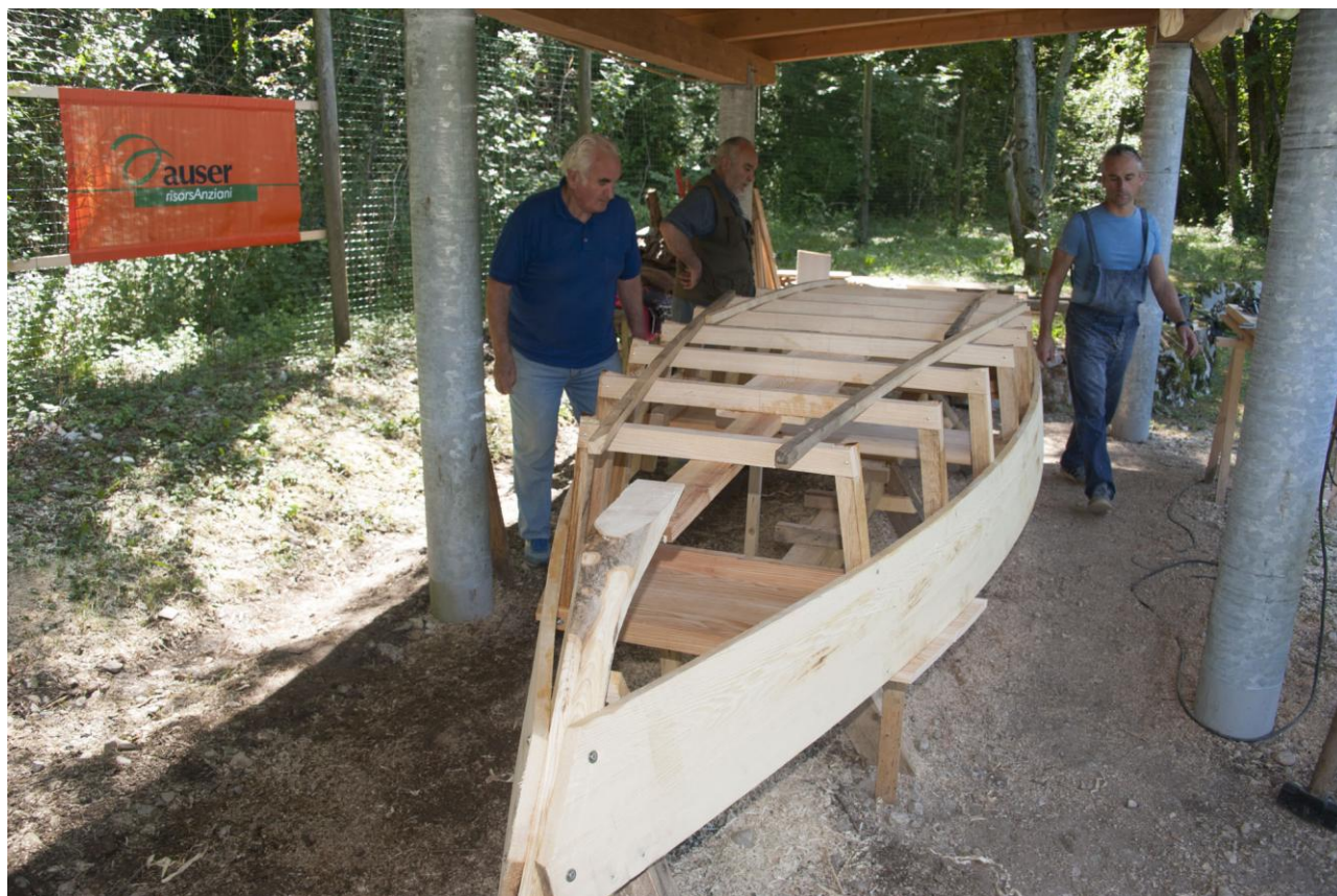
La preparazione del fondo della barca
