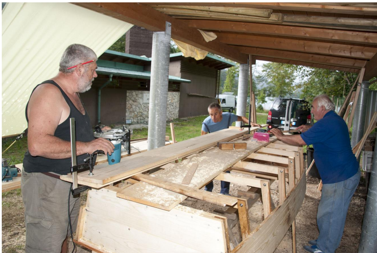
La realizzazione del fondo della barca
