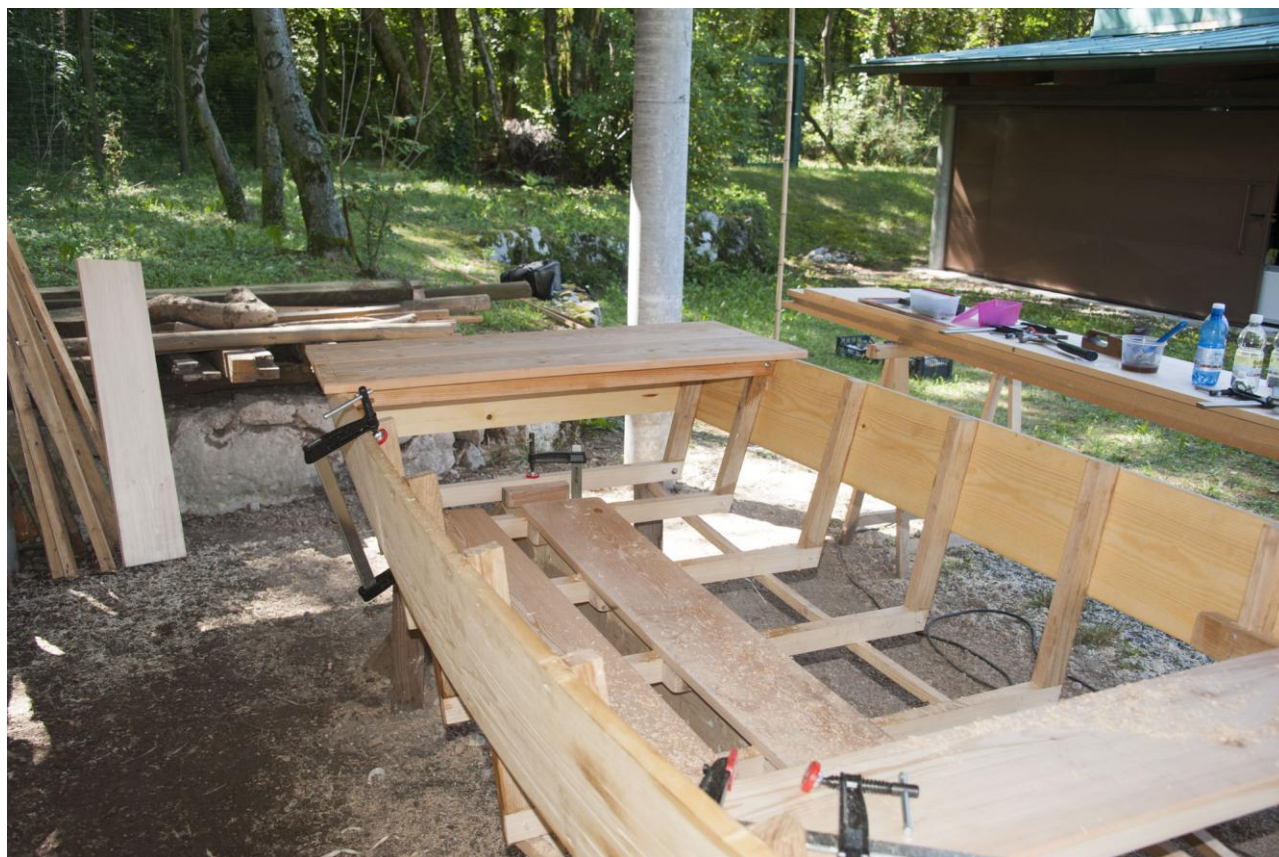
Posizionamento della panca di poppa, di quella del rematore e del pagliolo (pavimentazione interna)
