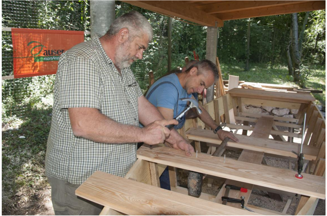
Maurizio (maestro d'ascia) e Piero (collaboratore veneziano) mentre montano le sovrastrutture di prua con Albano (pescatore di Alesso) che ricorda le caratteristiche delle barche di Alesso
