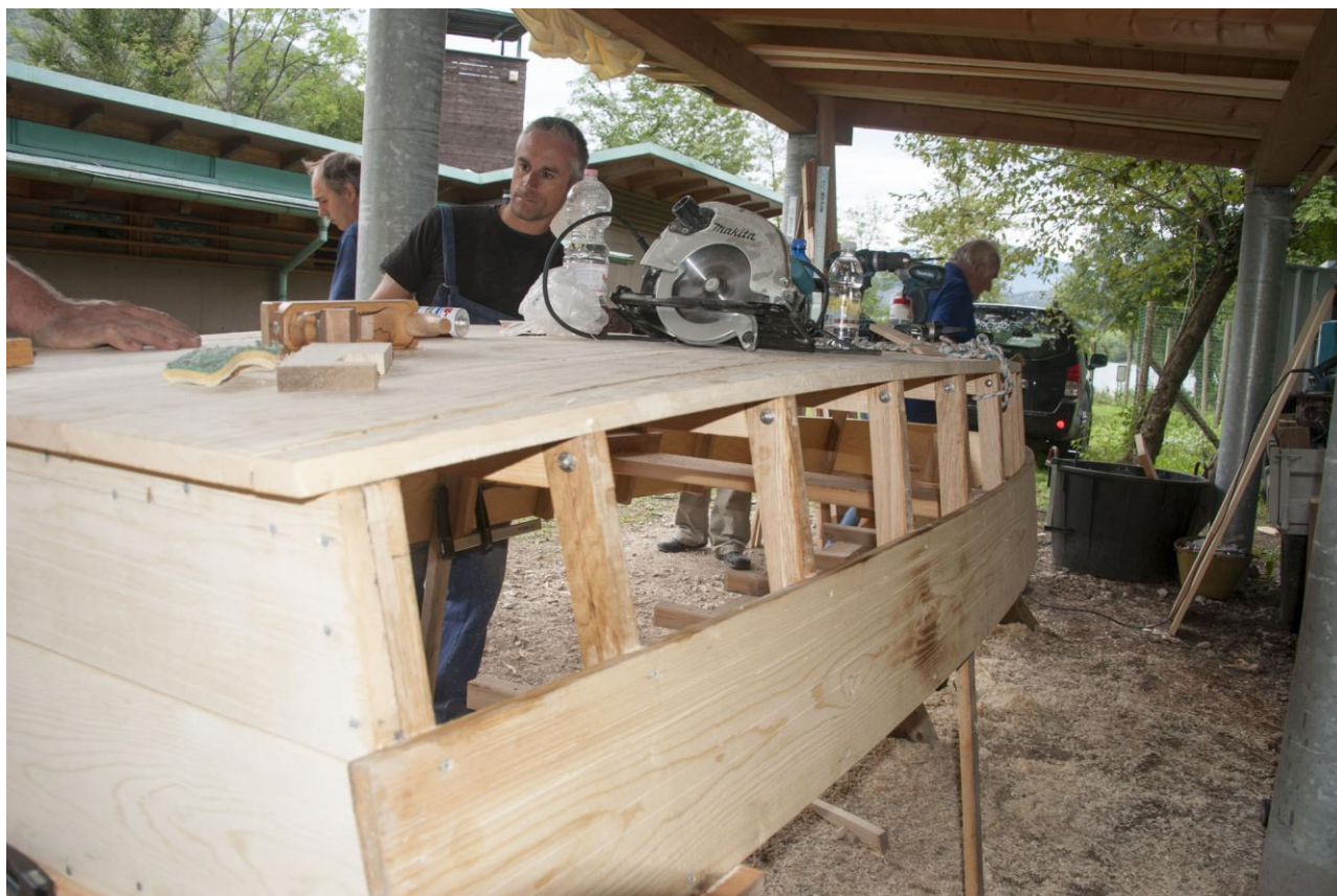
La preparazione della posa delle tavole del fasciame
