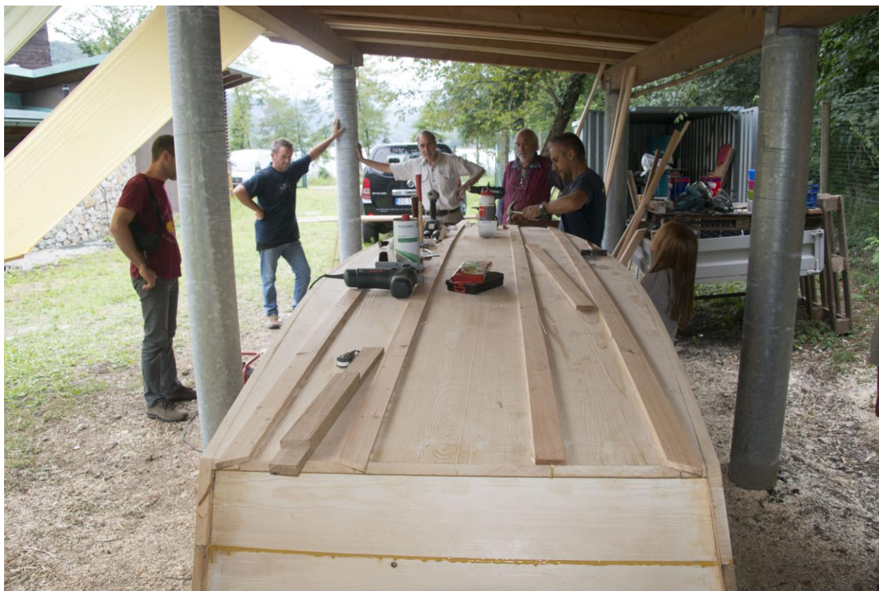
Posizionamento dei listelli di protezione del fondo scafo e vista dei remi
