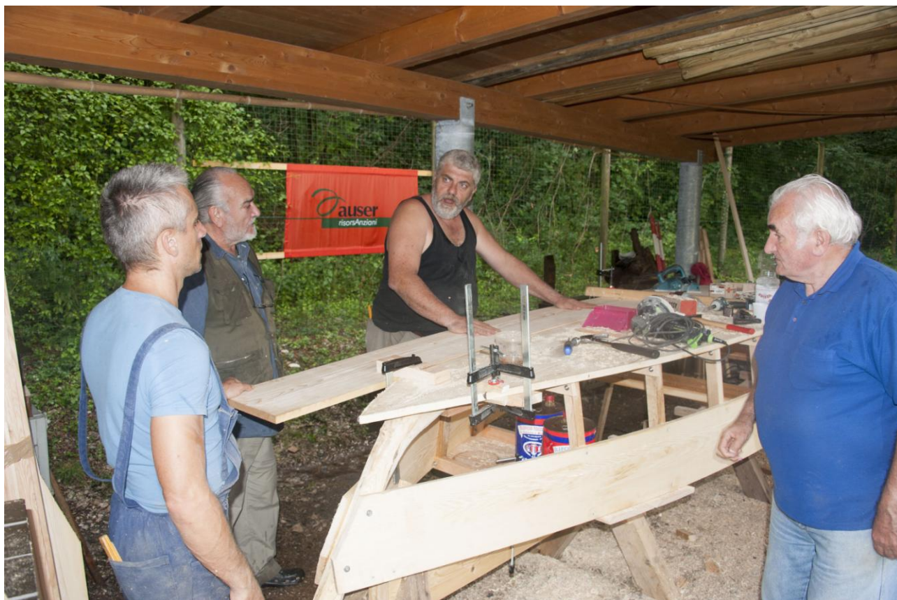
La realizzazione del fondo della barca
